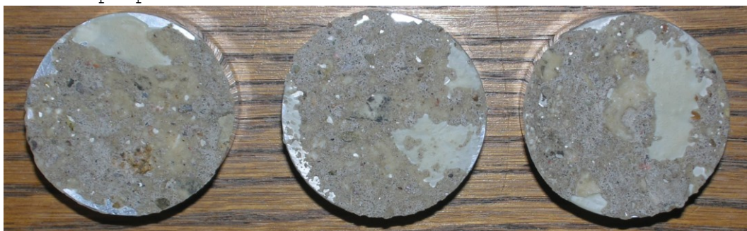
Obr.F47-112 Zkušební terče číslo 156, 181, 193 (zkušební místo 2) po provedení odtrhu.
