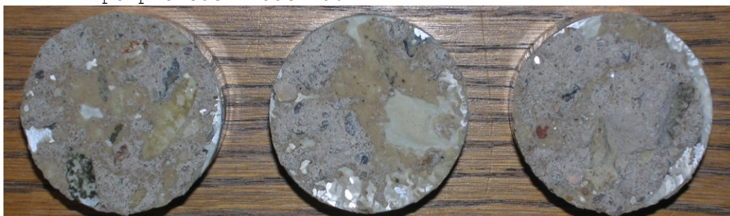
Obr.F47-114 Zkušební terče číslo 163, 185, 197 (zkušební místo 4) po provedení odtrhu.
