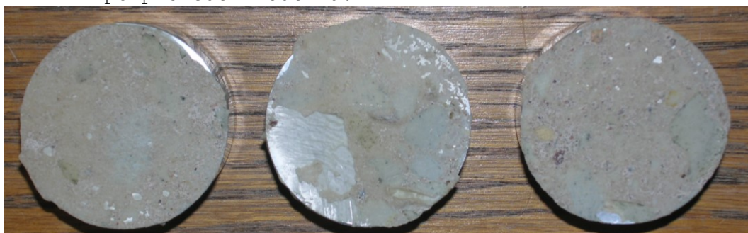
Obr.F47-115 Zkušební terče číslo 154, 188, 189 (zkušební místo 5) po provedení odtrhu.
