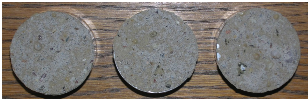
Obr.F47-111 Zkušební terče číslo 168, 179, 192 (zkušební místo 1) po provedení odtrhu.
