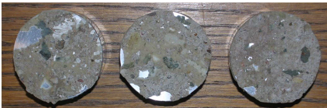
Obr.F47-116 Zkušební terče číslo 166, 167, 175 (zkušební místo 6) po provedení odtrhu.
