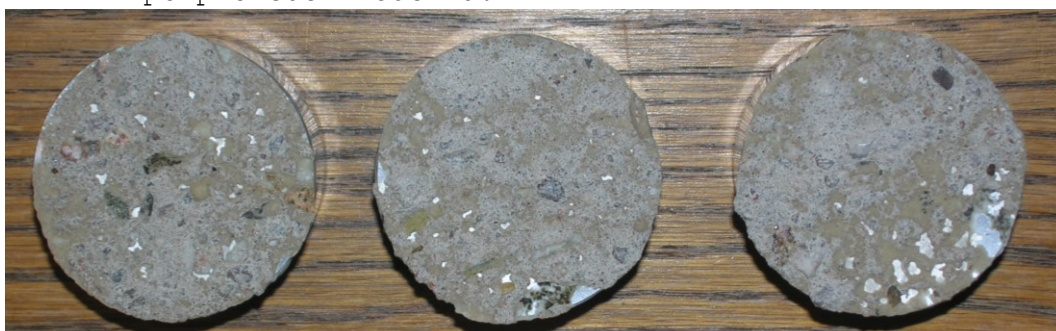
Obr.F47-113 Zkušební terče číslo 169, 176, 184 (zkušební místo 3) po provedení odtrhu.
