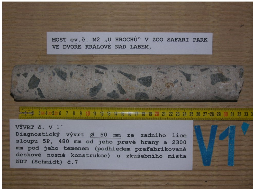
Obr. F41-1' VÝVRT č. V1'. Diagnostický vývrt \varnothing 50 mm ze zadního líce sloupu 5P, 480 mm od jeho pravé hrany a 2300 mm pod jeho temenem (podhledem prefabrikované deskové nosné konstrukce). U zkušební místa NDT (Schmidt) č.7.
